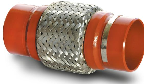
I giunti di espansione con treccia CONA sono formati da soffietti in acciaio inox corrugati anulari e da una treccia in acciaio inox molto resistente. Essi sono progettati per una resa ottima nelle applicazioni con vibrazione e pertanto per ridurre le vibrazioni nei sistemi di tubature meccaniche.
